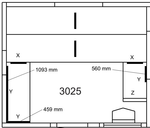
Skruta fast X-reglar på övre och nedre laven. Kapa den ena 1093-regeln enligt skiss. Skruva fast de övre Y-reglarna 850 mm från golv och den kapade regeln 380 mm från golv. Lägg på de färdigmonterade lavarna.
