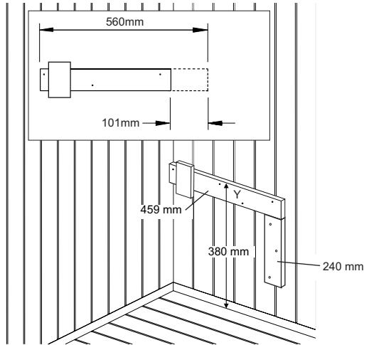
Den 350 mm-Riegel an der unteren Pritsche und den Y-Riegel an der Wand festschrauben. Armlehne montieren (2025/2025C)
