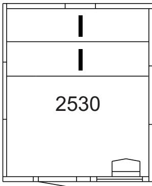
Skruta fast lavreglarna på vänster och höger vägg, kloss mot den bakre väggen. Lägg på de färdigmonterade bakre lavarna och montera mittstöden.
