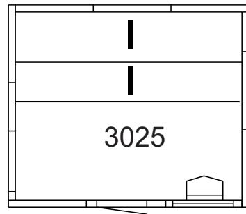
Riegel für die Pritsche an der linken und rechten Wand mit dem Klotz gegen die hintere Wand festschrauben. Die fertigmontierte hintere Pritsche auflegen und Mittelstütze montieren.
