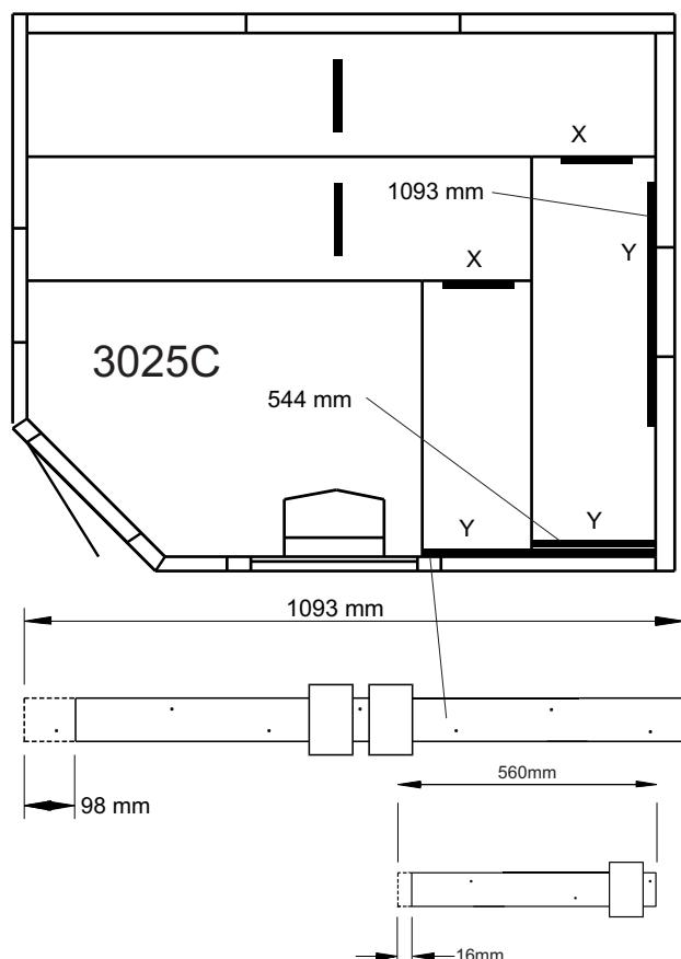
Schroef de X-latten op de onderste en de bovenste bank. Zaag één van de 1093-latten op maat volgens de schets. Schroef de bovenste Y-latten op 850 mm van de vloer en de afgezaagde lat op 380 mm van de vloer. Leg de geprefabriceerde banken op hun plaats.
