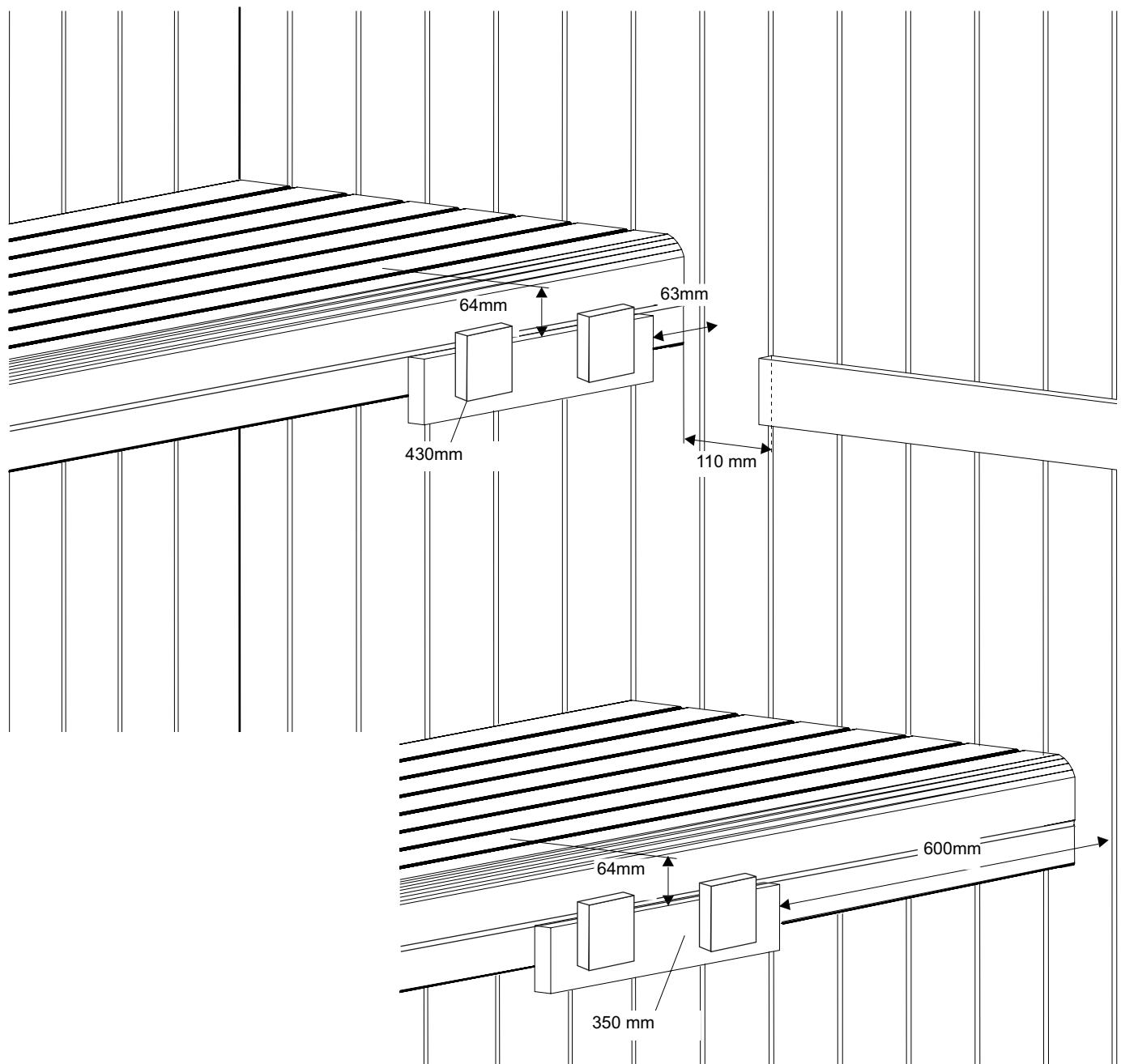
Ställ ryggstödet på en 90mm kloss. Markera centrum ovanför varje upphängningsstöd. Skruva dit en (4,0x35mm) skruv vid varje markering så att den sticker ut ca 5mm. Häng på ryggstödet.
