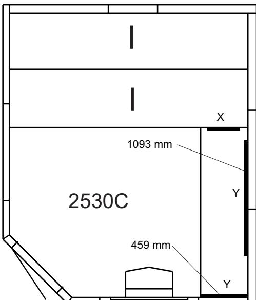
Skruta fast X-reglarna på den nedre laven och Y-reglarna mot vägg. Montera armstödet. Montera dekorrastrerna. Lägg på de färdigmonterade lavarna.
