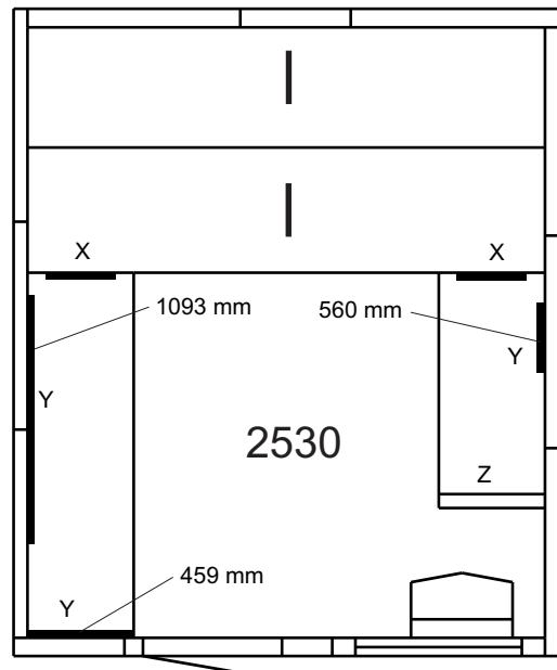
Skruta fast X-regeln på den nedre laven och Y-reglarna mot vägg. Lägg på den färdigmonterade laven.
