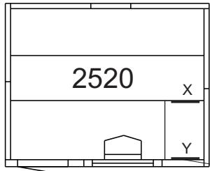
Skruta fast 350 mm-regeln (X) på den nedre laven och Y-regeln mot väggen. Montera armstödet (2025/2025C).
