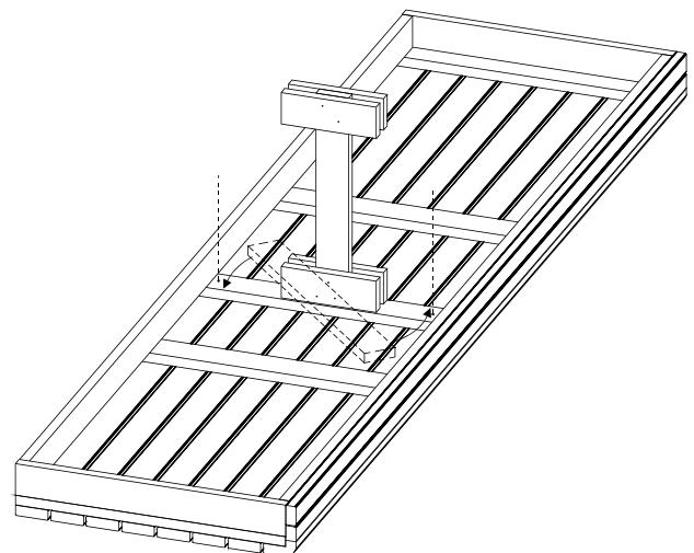
Skruta fast X-reglarna på den nedre laven och Y-reglarna mot vägg. Montera armstödet. Lägg på de färdigmonterade lavarna.
