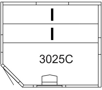
Visssez les tasseaux des banquettes sur les cloisons de droite et de gauche, les cales tournées vers la cloison du fond. Mettez ensuite en place les banquettes préfabriquées du fond et montez le support central.
