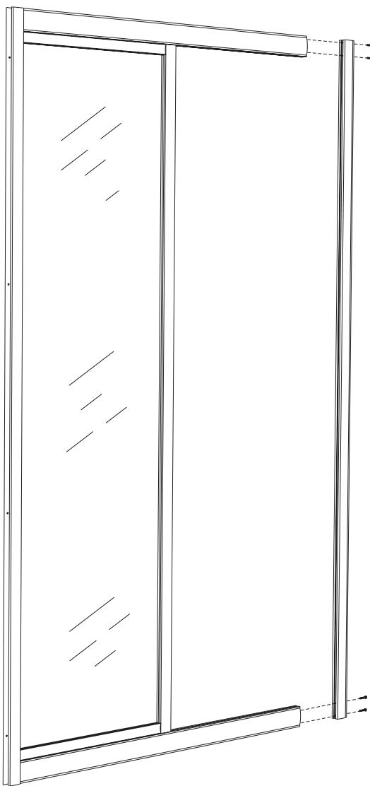
Placera duschedörren på sin avsedda plats. Markera var de yttre väggprofilerna skall fästas mot befintliga väggar. Vattra in, borra och skruva fast.
