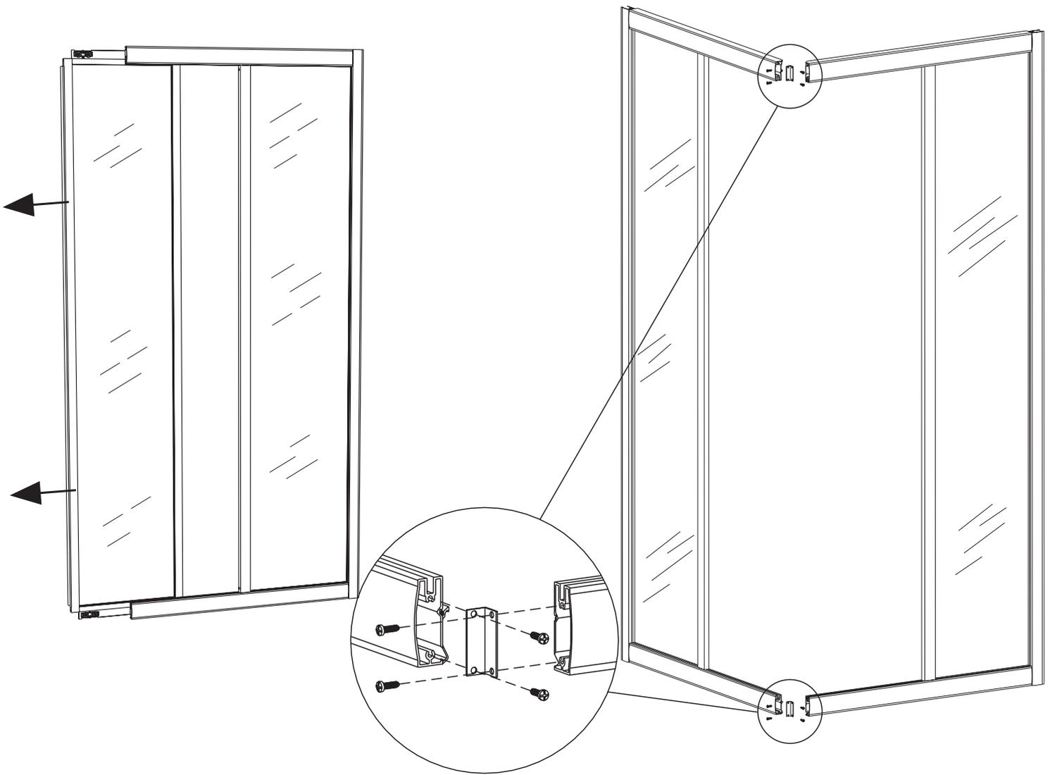
Placera dusch hörnet på sin avsedda plats. Markera var de yttre väggprofilerna skall fästas mot befintliga väggar. Vattra in, borra och skruva fast.
