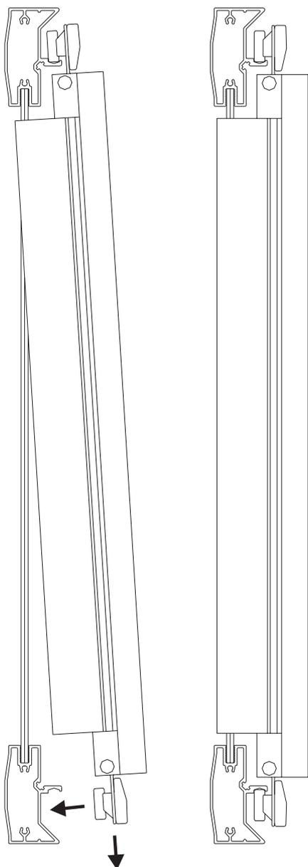
Den rörliga dörrdelen hängs på plats i de övre hjulbanorna, därefter snäpps de nedre fjäderbelastade hjulen fast i de nedre hjulbanorna.
